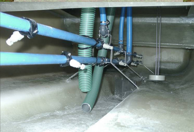
бак изнутри: 2 мешалки с инжекторными форсунками; поплавок для уровня заполнения; стенки, препятствующие образованию волн в баке
