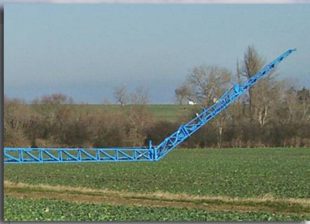
управление углом наклона, возможно с четырьмя сенсорами „Distance-Control“
