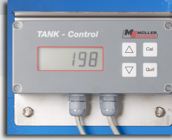
Tank-Control - электрический датчик количества жидкости
