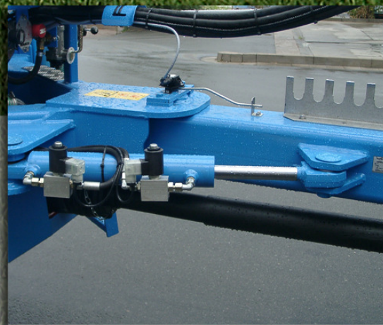
управление тяговым дышлом с автоматическим устройством движения по колее и блокировка с кабины трактора
