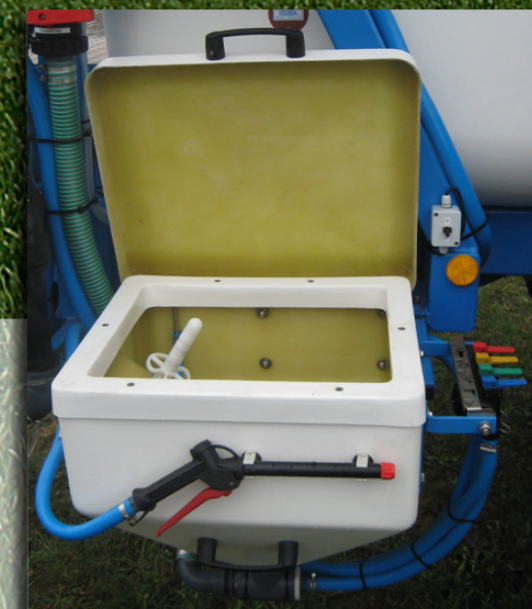
большая, стабильная воронка для размешивания; обозримые клавиши переключения
