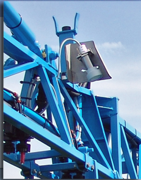
система включения отдельных секций с автоматическим управлением штангой „Distance-Control“ с ультразвуковыми датчиками
