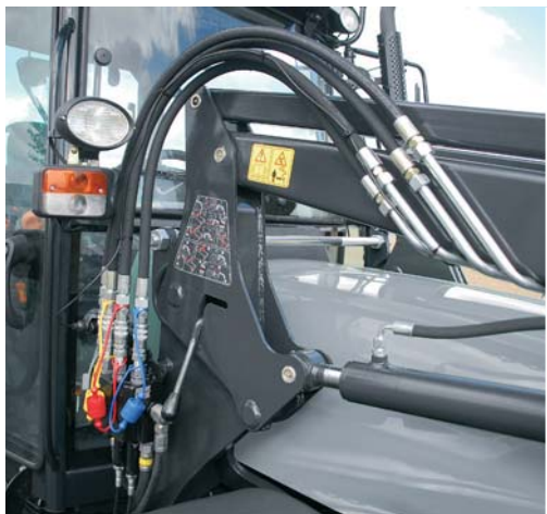
Быстрый монтаж/демонтаж погрузчика.
