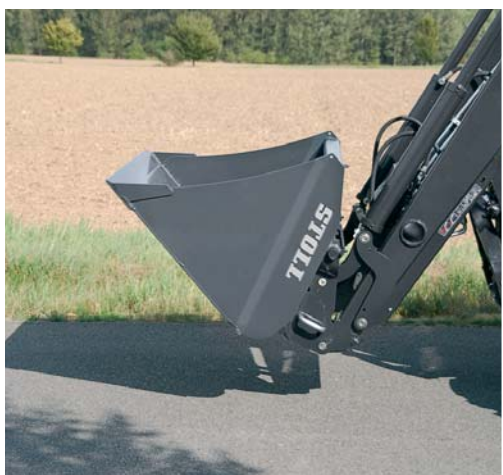
Отличные углы наклона: ECO 650/750: 43°. ECO 850/950: 46°.
