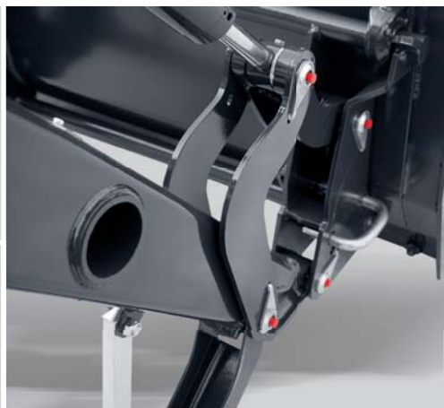
Быстросменная рама Евро-стандарта с установленным рабочим органом.
