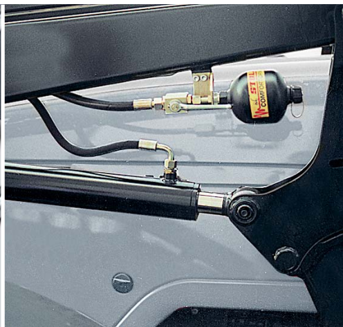
Система COMFORT-DRIVE – оборудование для амортизации фронтального погрузчика при движении с установленным поднятым погрузчиком – это щадит как водителя, так и трактор (возможно и как дополнительное оснащение).
