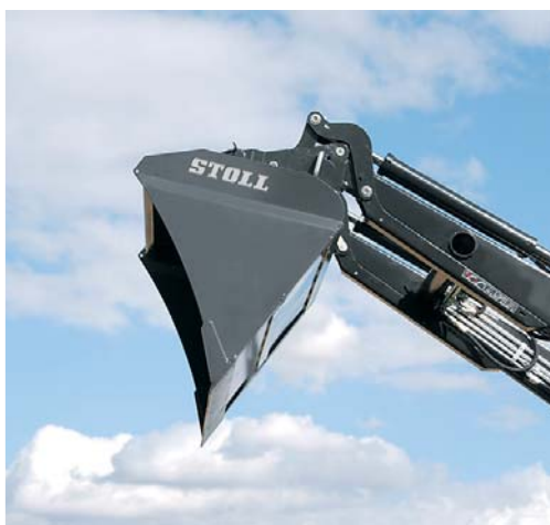
Очень хорошие углы опрокидывания: ECO 650/750: 63°. ECO 850/950: 58°.
